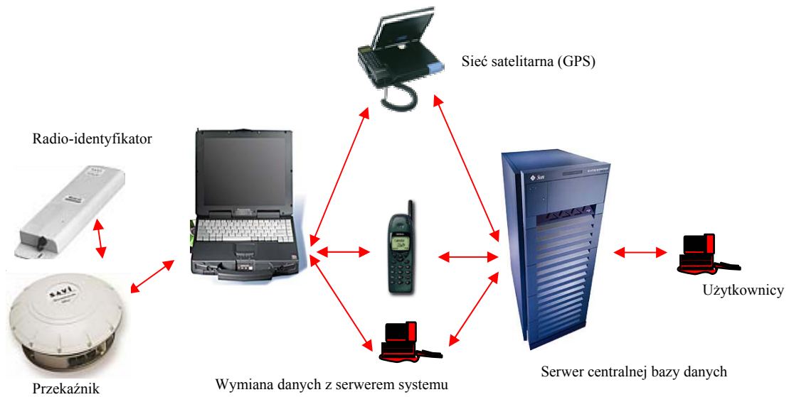
Rys. 1 Infrastruktura systemu śledzenia zasobów logistycznych.
